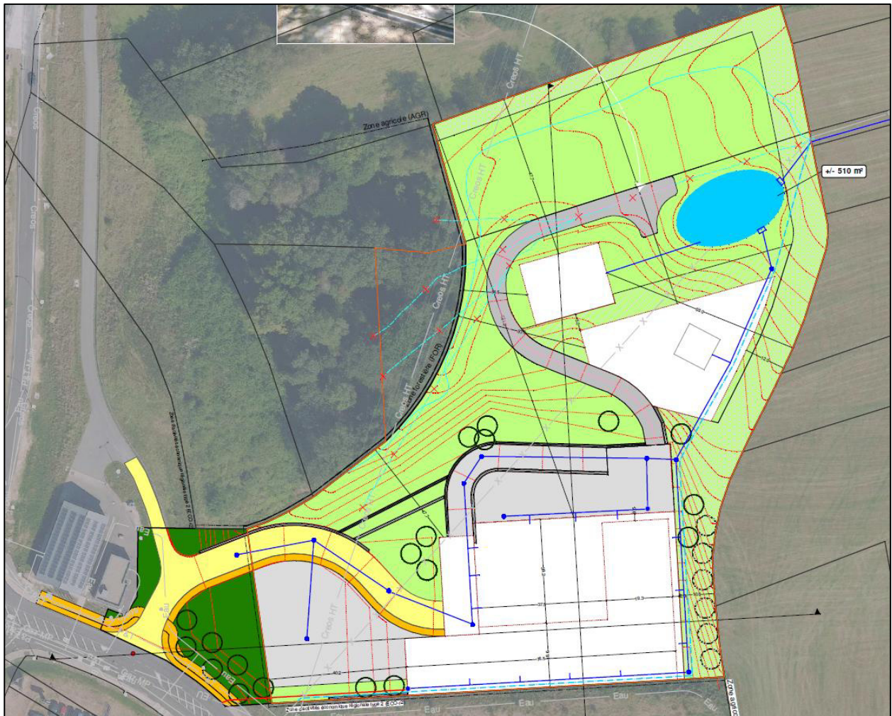
Abb. 25: Entwässerungskonzept des POS CIS Nordstad, ohne Maßstab. Quelle: Beissel & Ruppert, Structural Engineering Plan 2953-0-003 Indice B „Plan des réseaux projetés“, Stand 12.01.2023.
