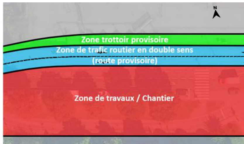
Figure 2 : Schéma de phasage insertion en surface du tram : phase 2
