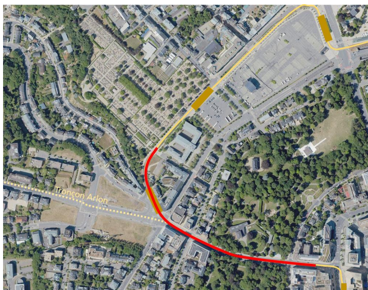
Figure 7 : Raccordement Etoile - Proposition voie unique pour la voie au Sud (en rouge) lors des travaux de raccordement avec un aiguillage californien. La ligne existante est représentée en jaune. Source : Groupement 2025
