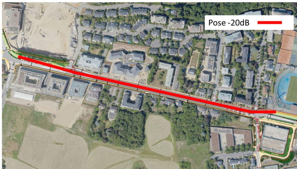
Figure 23 : Préconisation des poses de voie tranchée couverte, valable pour les 2 niveaux de critères VDI, vitesse de circulation de 50km/h
