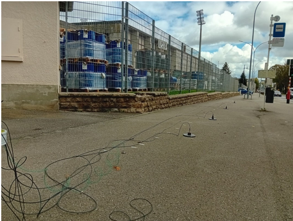
Figure 8 : Exemple de mesure de transfert vibratoire avec une masse d'impact
