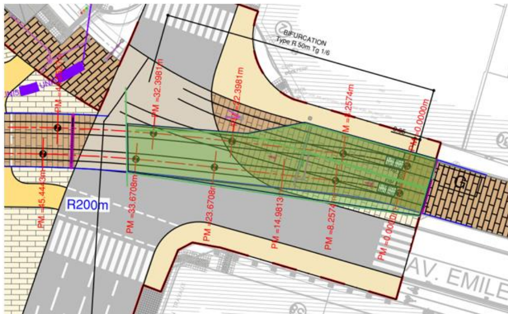
Figure 5 : Identification de la reprise de voie ferrée de la ligne 1 existante pour la réalisation de l'extension Route d'Arlon, source : Groupement 2025
