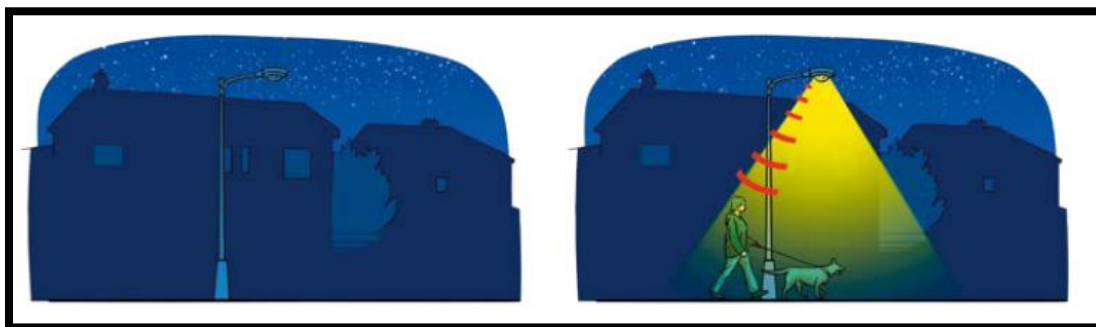
Figure 44 : Schémas indication des possibilités de gestion des lampadaires : gestion des niveaux en fonction du moment de la nuit et radar de détection pour allumer en cas de passage, source : Groupement 2025
