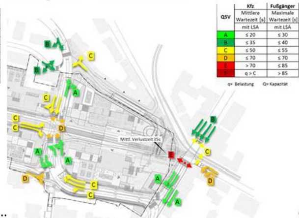
Figure 38 : Extrait du concept de mobilité et étude de trafic relatif au PAP Place de l'Etoile –simulation du trafic comprenant le réseau routier projeté, le trafic supplémentaire et les hypothèses sur un futur concept bus et tram. Légende : Qualité A-D(vert-jaune-orange) : suffisante ; qualité E-F (rouge) : insuffisante (Schroeder & associés, 2021).
