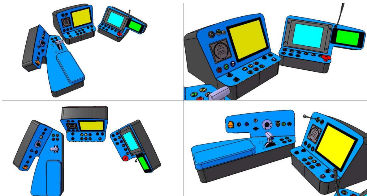
Figure 7. Nouveau pupitre de conduction URBOS
